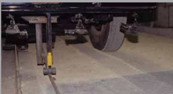
1996 – Funcția de confinare laterală a geogridurilor Tensor conduce la reduceri semnificative ale adâncimii fagășului.
