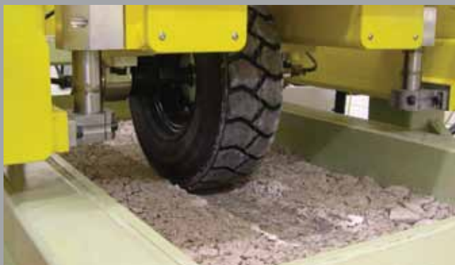
2007 Centrul de Tehnologie Tensor – Instalațiile proprii pentru testări permit investigarea geogridurilor, umpluturii și fundației.
