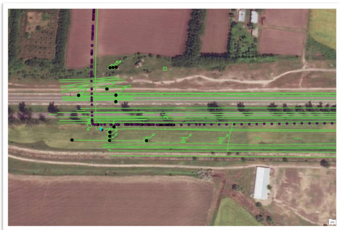
Figura 7: Vizualizarea informațiilor din măsurători (preluate din AutoCAD – linie marcată cu verde), suprapuse peste ortofotoplan și cu suprapunerea informațiilor obținute din godevilarea inteligentă (traseu conductă cu puncte mov)
