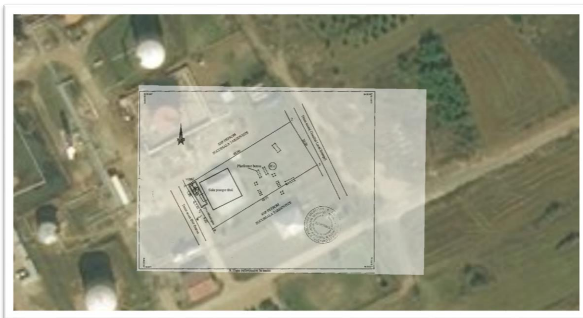
Figura 9: Suprapunerea unui plan de situație 1:500 scanat peste un ortofotoplan, utilizând coordonatele colțurilor planului
