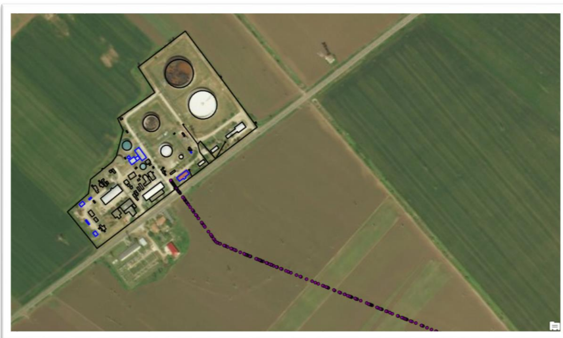
Figura 8: Suprapunerea informațiilor cadastrale pentru o stație dintr-un fișier AutoCAD peste un ortofotoplan, împreună cu informații de poziționare a conductei din fișierul Excel cu informații din godevilarea inteligentă
