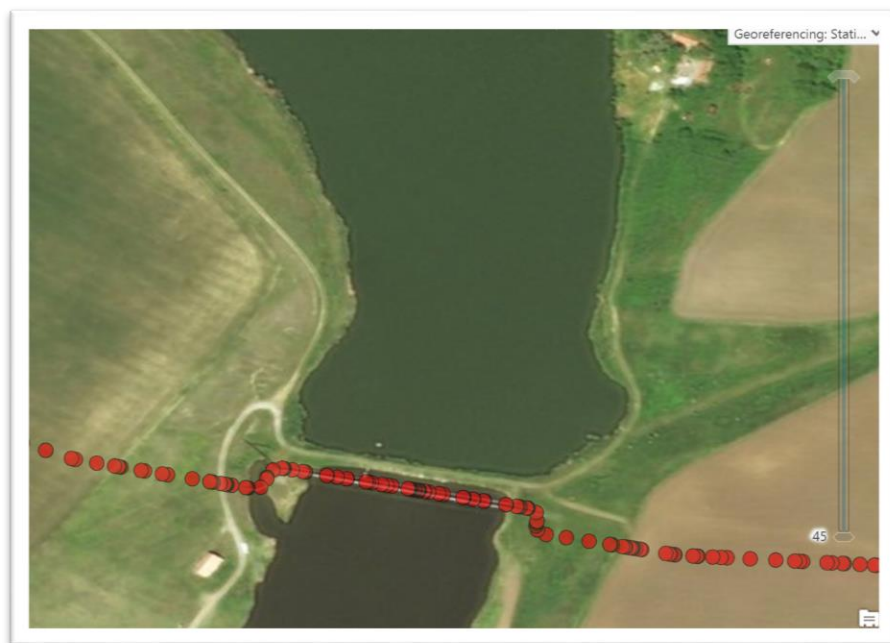
Figura 4: Date provenite din godevilarea inteligentă, preluate dintr-un fișier Excel și suprapuse peste ortofotoplan
